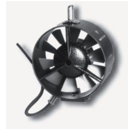
Besonderheit zum 14433: Wenn die Luftströmung der auf dem Schutzring markierten Pfeilrichtung entgegengesetzt ist, zeigt das METEO DIGIT die Windgeschwindigkeit mit negativem Vorzeichen an.
